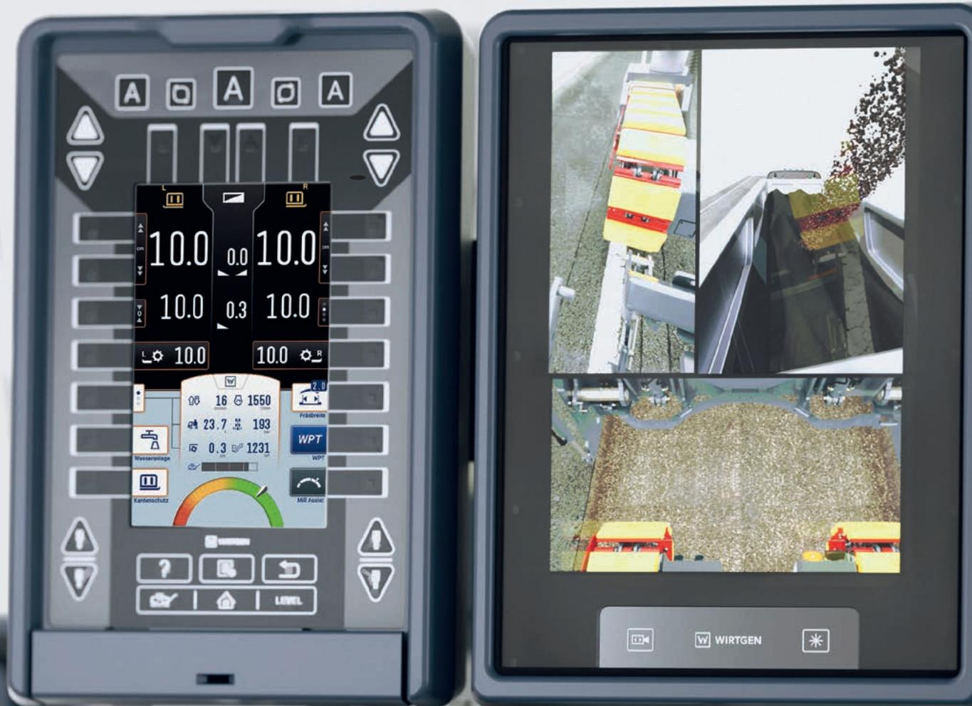
1 | 10"-Bedienpanel mit Split Screen zur gleichzeitigen Anzeige mehrerer Kamerabilder.
