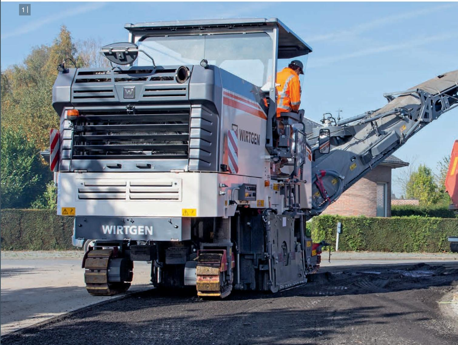
1 | Hohe, variable Bandgeschwindigkeit und große Bandschwenkwinkel sorgen für flexible Fräsgutverladung.
