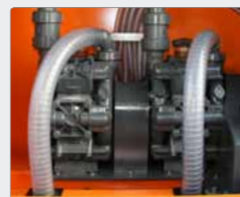
Logisk opbygget væskesystem med membranpumpe.
