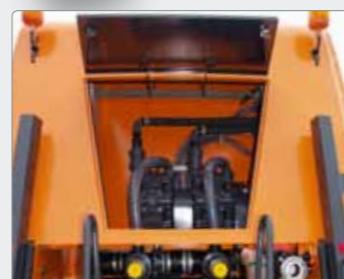
Servicevenligt maskinrum med hurtig adgang til computerenhet, ventiler og væskepumper.
