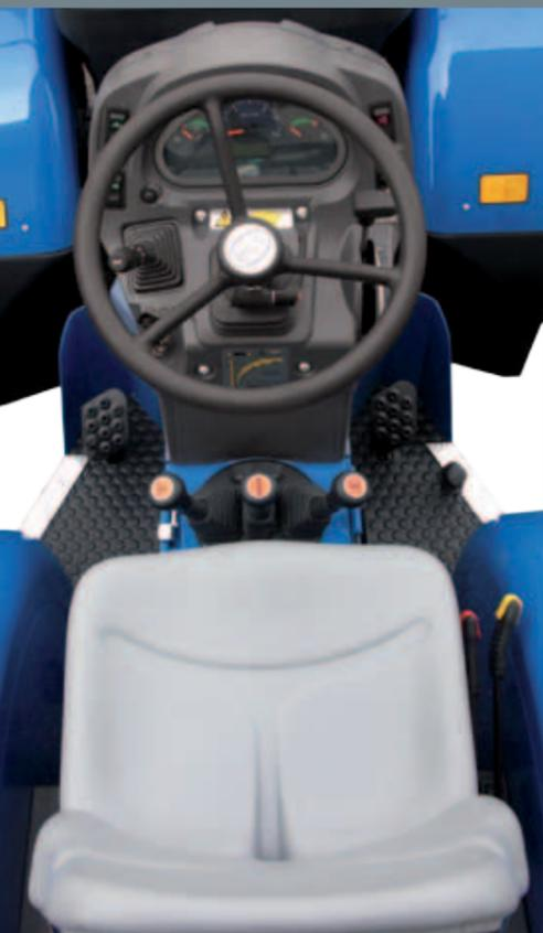
La **strumentazione** digitale è inserita in modo elegante in una consolle con schermo antiriflesso e prevede la lettura dei giri motore, velocità di avanzamento e velocità di rotazione della presa di forza.
