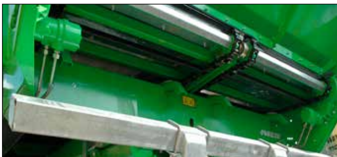
Transportbodenantrieb über zwei Hydraulikmotoren
