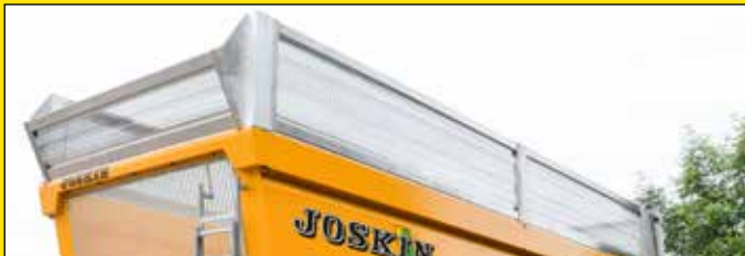
Vergitterte Bordwanderhöhen Typ "Silage"
