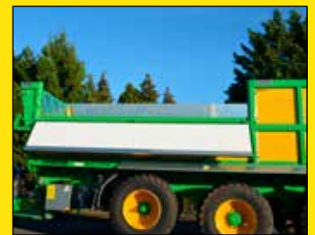
Hydraulisch einklappbare Seitenwände
