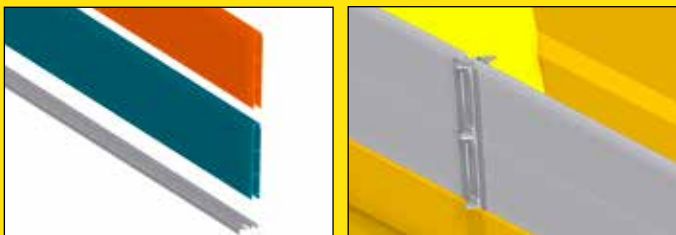
Ineinander steckbares System der Aluminium-Bordwanderhöhen
