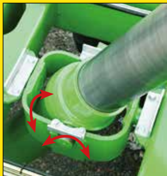
Doppelt schwingbarer Rahmen, in dem der Kippzylinder angebracht ist.
