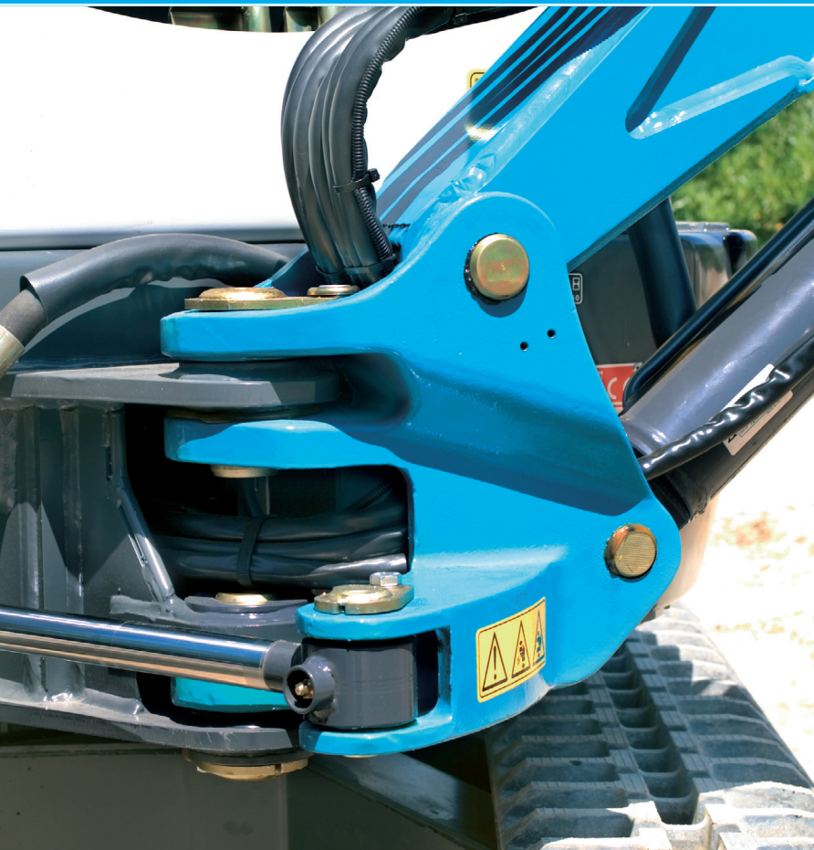
Detail of the excavating arm articulation /Detail Armgelenk / Йипвбэжойж щбсойсогдл тпжейокой" рмжшб
