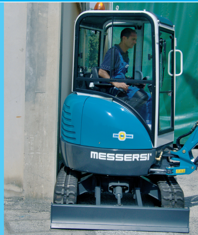
Detail of the rotation of the machine (zero tail swing) / Detail der Rotation innerhalb des Maschinenprofils (Zero Tail Swing) / Иипсбэжойж сбипспуб л поуфсб нбщюб (офмжгпк сбипбц ибсжжк шбтуй)
