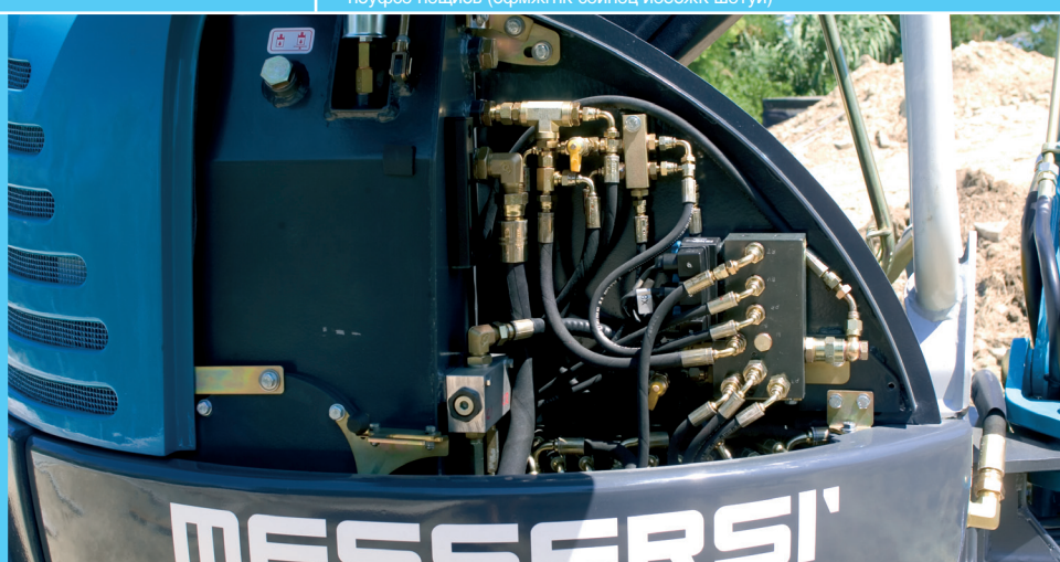
Detail of the access to the distributor / Detail vom Zugang zum Verteiler / Ежубмэ ентуфрб л сбтрсежмйужмя
