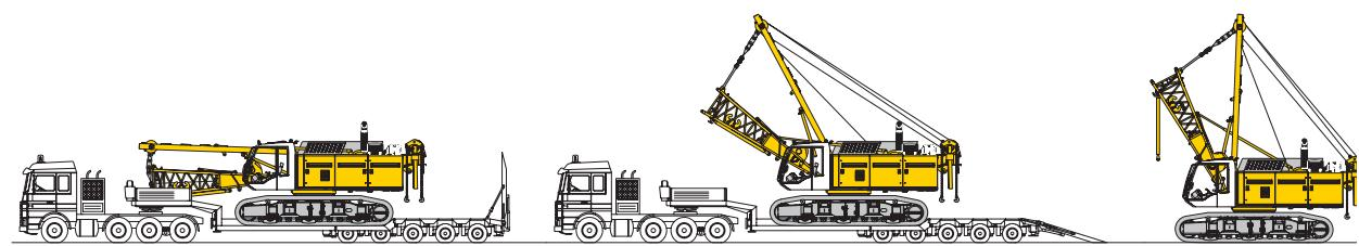
Разгрузка базовой машины (стандартный вариант)
