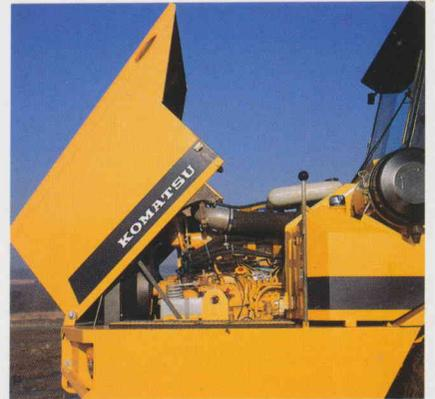
Tous les filtres (plein-débit, à carburant, transmission et hydrauliques) sont concentrés sur le côté gauche de la machine, de sorte que leur remplacement est rapide et simple. La position basse du réservoir à carburant et du réservoir hydraulique permet de faire l'appoint sans difficulté. Le capot du HA270 est inclinable de façon à faciliter les interventions sur le moteur.
