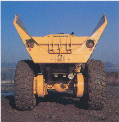
Le HA270 est sur simple châssis coulissant, lequel est conçu de façon à ce que le plancher soit bien plat et que l'extrémité en forme de chaland ne soit plus nécessaire. Ceci a également l'avantage d'améliorer la stabilité de la charge et la sécurité du conducteur de travaux. Normalement prévue pour des capacités de charge importantes, la ridelle arrière, qui fonctionne automatiquement avec un système à air comprimé est idéale pour la manipulation des matériaux friables et secs.
