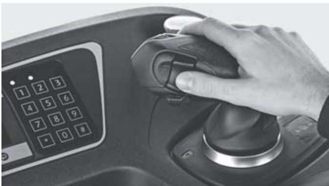
Optionaler Joystick 4Plus für Hub-, Senk- und Fahrsteuerung ohne Umgreifen
