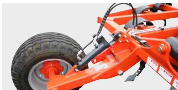
CU1000T: Gł bok o robocz z przodu reguluj koła kopij ce
