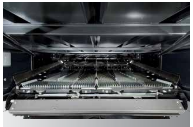
Het elektrische regelsysteem (optioneel) voor openen en sluiten van de zeven zorgt voor onmiddellijke aanpassing aan de oogstsituatie.
