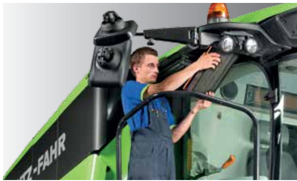
CABINEFILTERS. Eenvoudige vervanging cabinefilters, zonder gereedschap.
