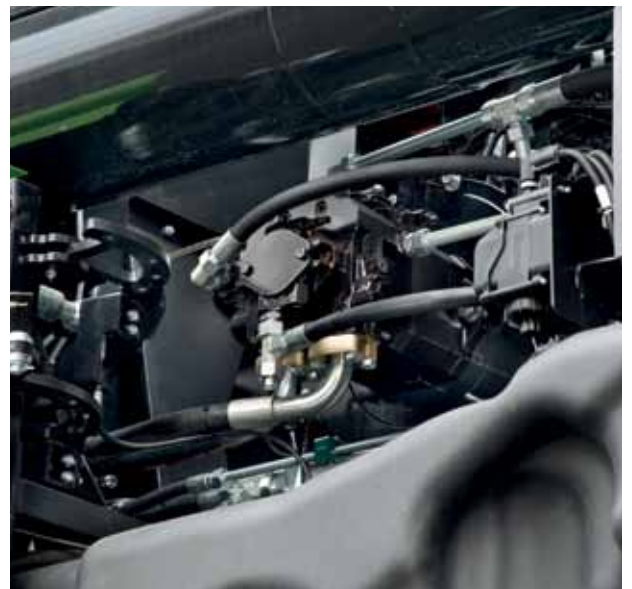
POMPA VARIABILE. La pompa idrostatica è flangiata direttamente sul motore.
