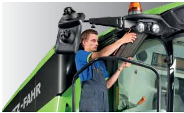
FILTRI CABINA. Sostituzione filtri cabina semplice e senza utensili.
