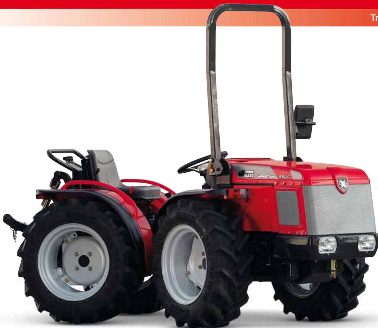
Der **Supertigre 5500** ist der neue Knicklenker der Serie 21. Dank seiner **extrem schmalen** Bauform kann dieser Knicklenker wendig in die engsten Kulturen eindringen. Der **starke Lenkeinschlag** beschleunigt die Arbeit, die mit größter Genauigkeit auf unübertroffene Weise in den Pflanzenzeilen der Sonderkulturen und an stark abschüssigem Gelände ausgeführt werden kann.
