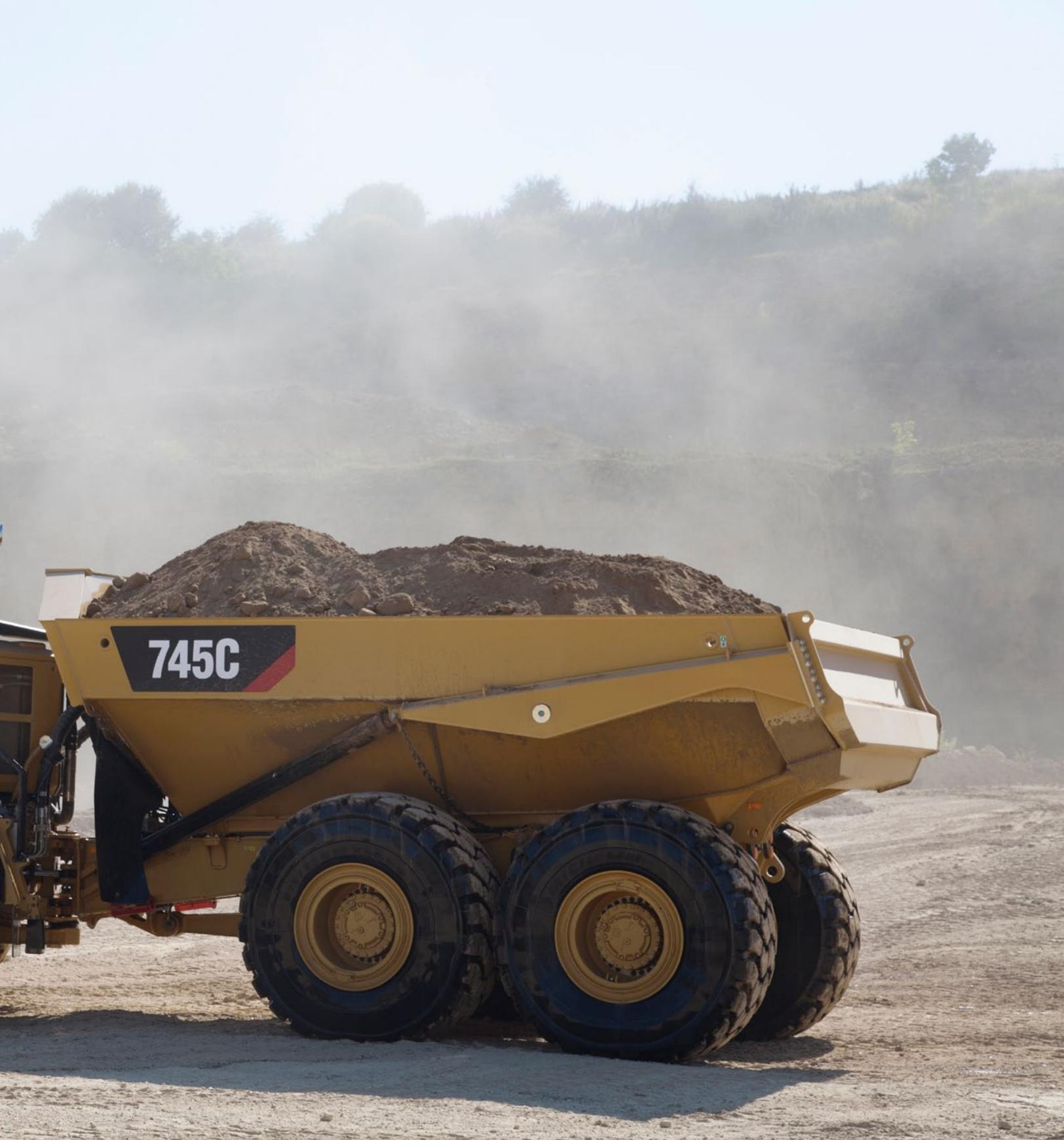
**Der Cat 745C mit einem vergrößerten Fassungsvermögen von 25 m<sup>3</sup> bzw. 41 Tonnen bietet bewährte Zuverlässigkeit, Haltbarkeit, hohe Produktivität, besonders guten Fahrerkomfort und geringere Betriebskosten.**
