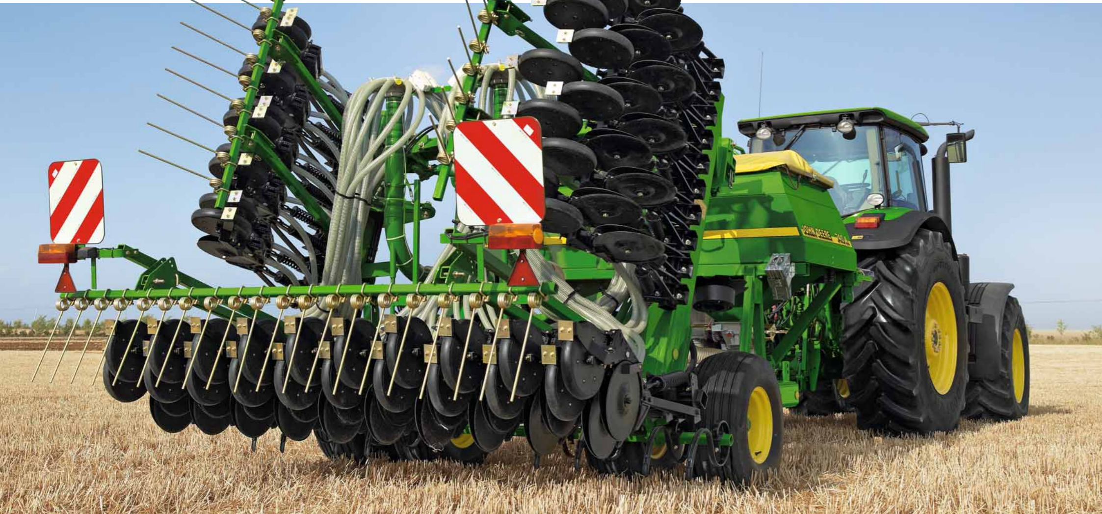
D'une largeur de travail pouvant atteindre 9 m, le semoir 740A délivre des performances exceptionnelles au champ. Et en transport sur route, sa largeur n'est que de 3 m !
