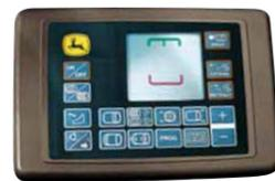
Rozměr balíku, zapnutí/vypnutí nožů a odstranění ucpávek lze ovládat z kabiny pomocí monitoru BaleTrak Plus.
