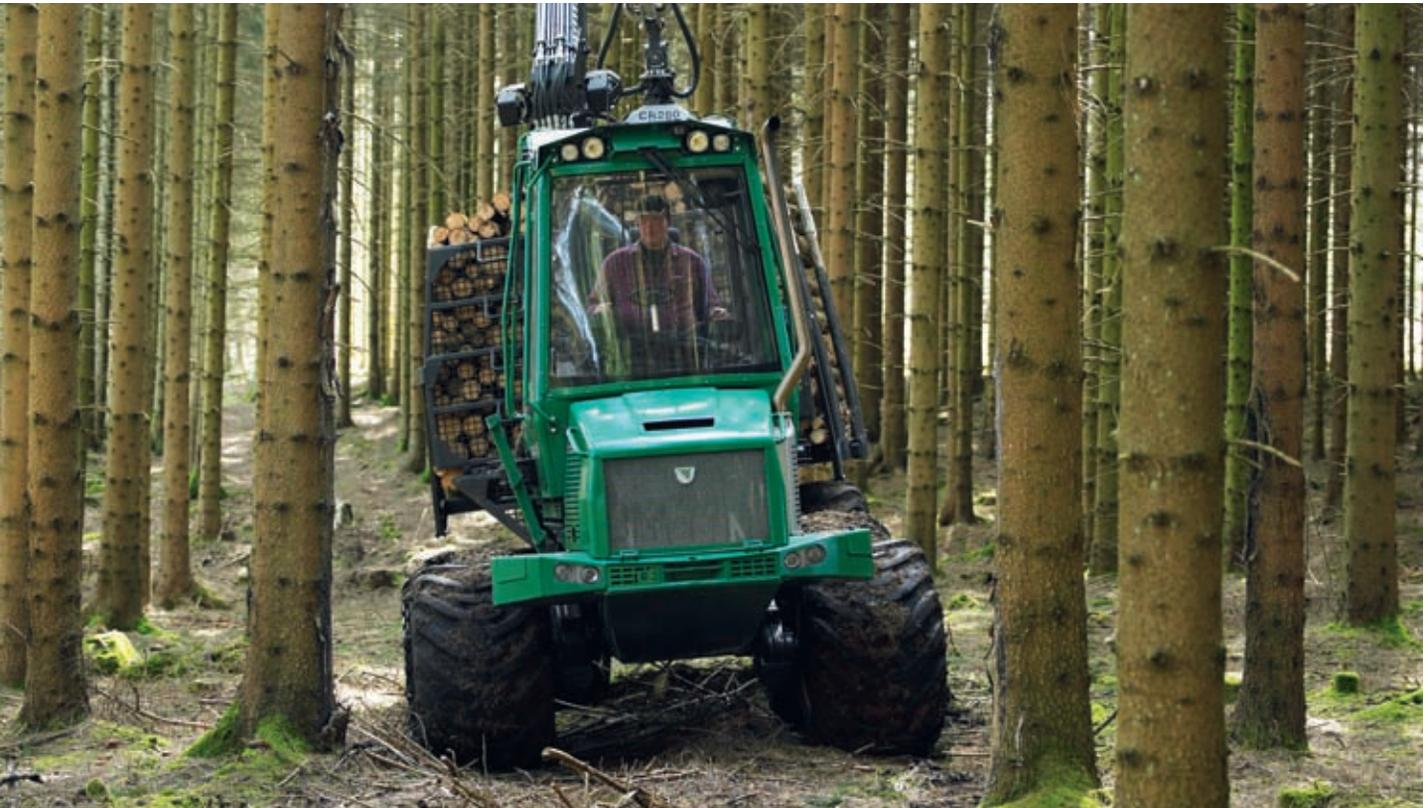
Warum Zeit für kurze Stopps verschwenden, wo jede Sekunde zählt. Mit dem Powershift-Getriebe schalten Sie ohne anhalten zu müssen, auch wenn die Maschine voll beladen ist. Ihre Durchschnittsgeschwindigkeit wird erhöht und Sie können mit niedriger Drehzahl fahren. Das ist sowohl wirtschaftlich als auch angenehm aus ergonomischer Sicht.
